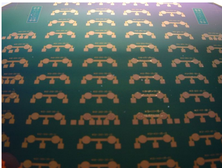
Abb. 5 Wafer mit Schaltstrukturen
